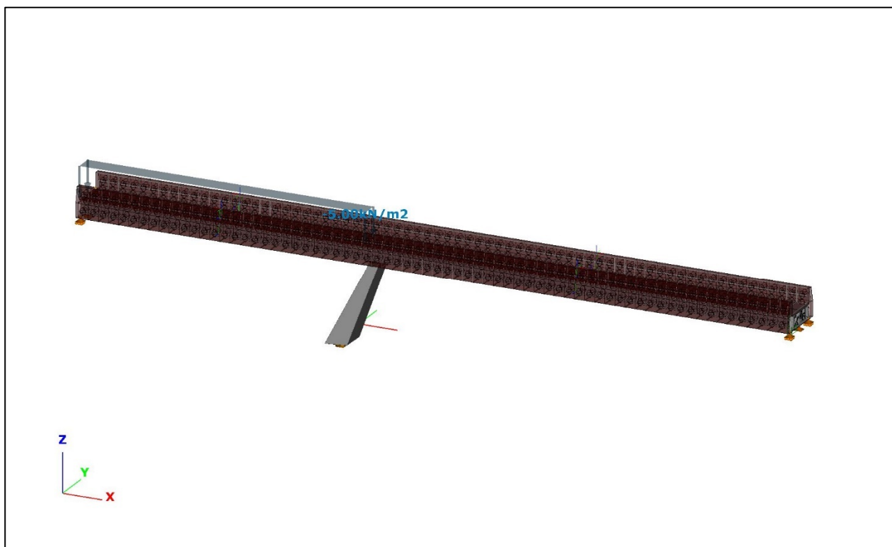
Fig. 6-5 – Sovraccarico variabile da folla Sx, campata B
