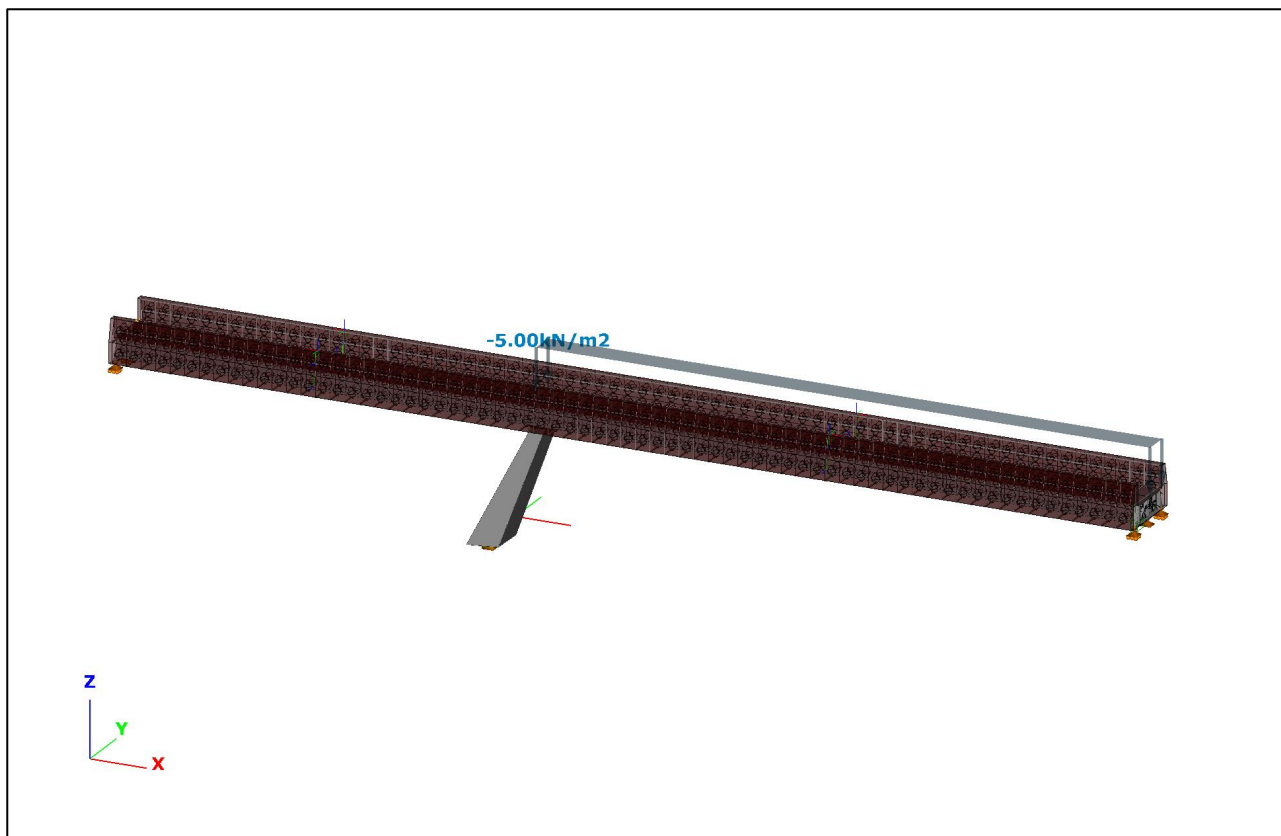
Fig. 6-4 – Sovraccarico variabile da folla Dx, campata A
