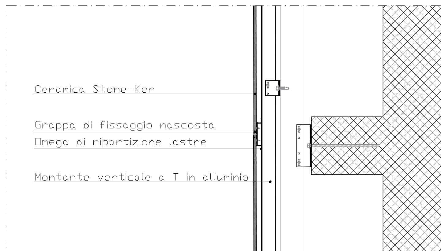
SEZIONE DETTAGLIO RIVESTIMENTO TORRI Scala 1:10
