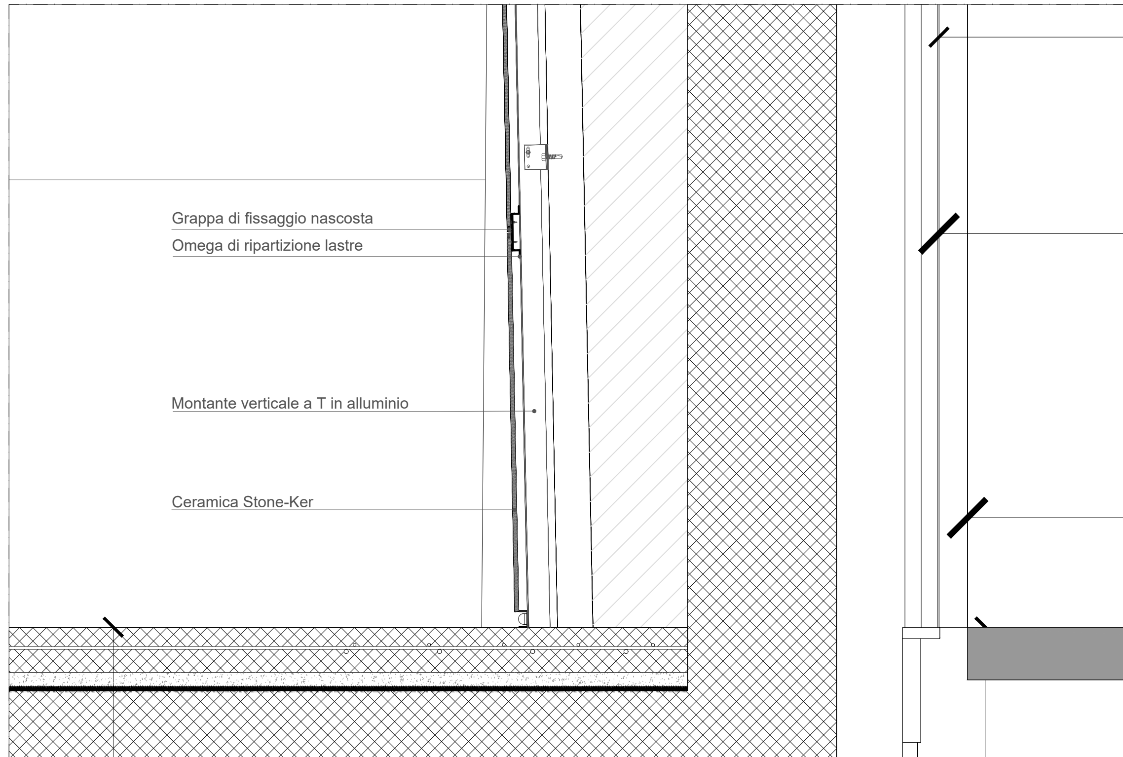
DETTAGLIO COSTRUTTIVO 2 - Sezione Scala 1:10
